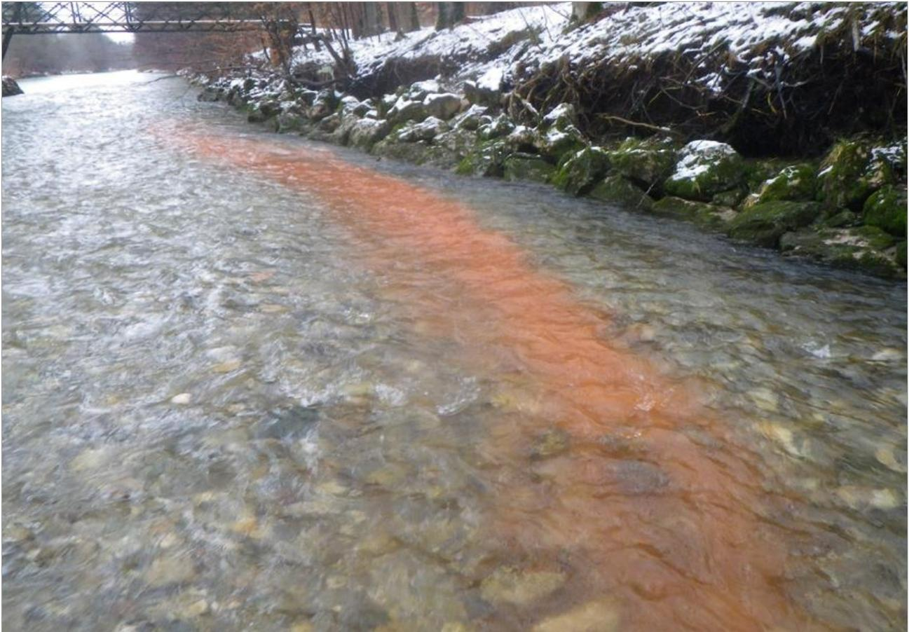
5 Kg Ziegelmehl wurden in 20 Sekunden eingebracht, der Farbstreifen ist ca. 20m lang
