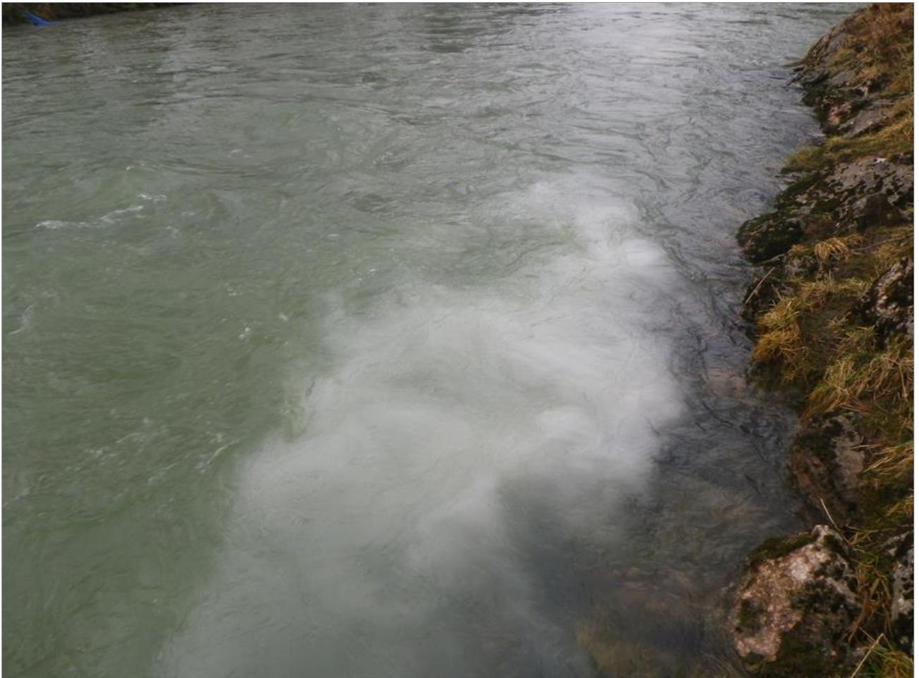
1 Kg Sägemehl wurde in Wasser angerührt und eingebracht, der Farbstreifen ist ca. 5m lang
